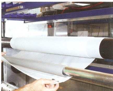
Sauber, ohne Ausfransen oder Verknicken, kommen die die Rollos aus der TFR 2200
